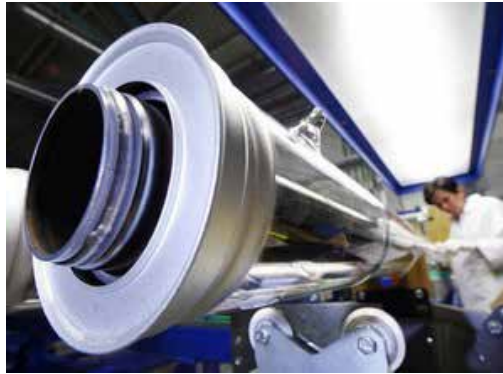
Şekil 2.20. CSP Alıcı Tüpü
